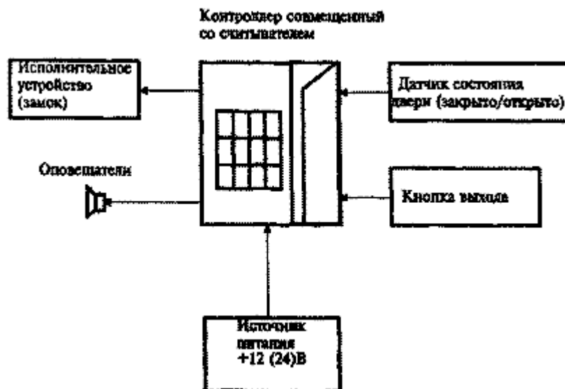
Рисунок 1 - Оборудование СКУД помещения с одной дверью
