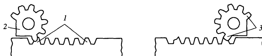
Рис. 6.18. Шибер и шиберная шестерня
